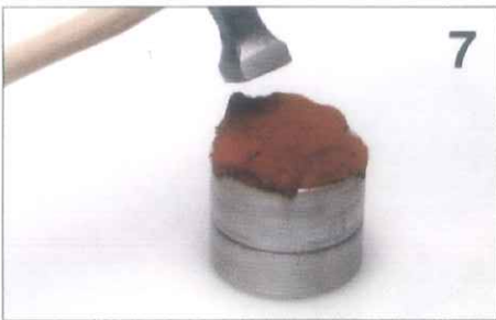
7. Den zweiten Ring mit Gießerde ausfüllen. Gießerde mit einem Hammer austampfen. Ueberflüssige Gießerde mit einem Lineal abstreichen.
