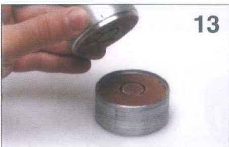
13. Die zwei Teile der Gießform wieder zusammen fügen. Die Einkerbungen genau gegenüber einander setzen. Die Gießform ist fertig zum Gießen.
