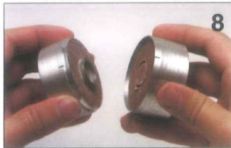
8. Achte darauf, das die Einkerbungen genau gegenüber einander bleiben. Die beiden Ringen vorsichtig voneinander trennen.
