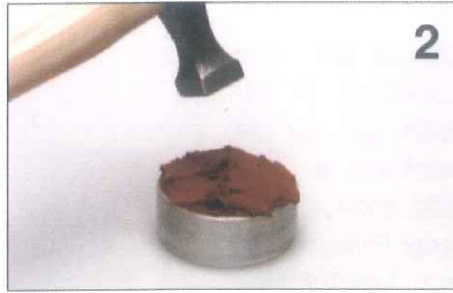
2. Den Ring mit der Gießerde ausfüllen. Die Gusserde mit einem Hammer austampfen.
