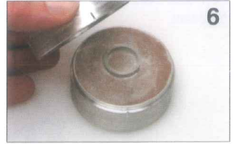
6. Den zweiten Ring auf den ersten stellen. Die Einkerbungen genau gegenüber einander setzen.
