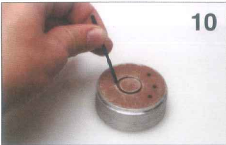
10. An der Nähe von das Modell ein Loch stechen damit ein Gießrohr entsteht. Gegenüber dem Gießrohr Entlüftungsröhre stechen.
