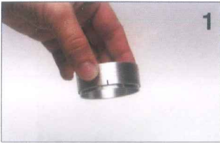
1. Den Ring mit hochstehendem Rand nach unter auf ebene Untergrund stellen.
