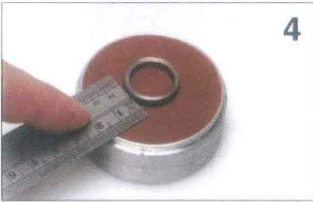
4. Den ausgefüllten Ring umdrehen. Das Modell bis zur Hälfte in die Gießerde drücken.
