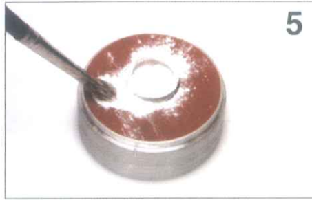
5. Ein bisschen Talkpulver auf die obere Fläche des Ringes streuen.
