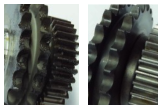
Abreinigen von Öl und Spänen
